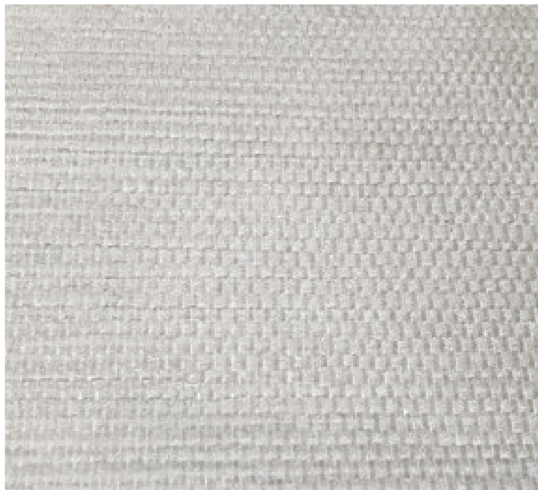
TESSUTO DI RIVESTIMENTO TECNICO IN FIBRA DI VETRO TECHNICAL FIBERGLASS COVERING FABRIC
